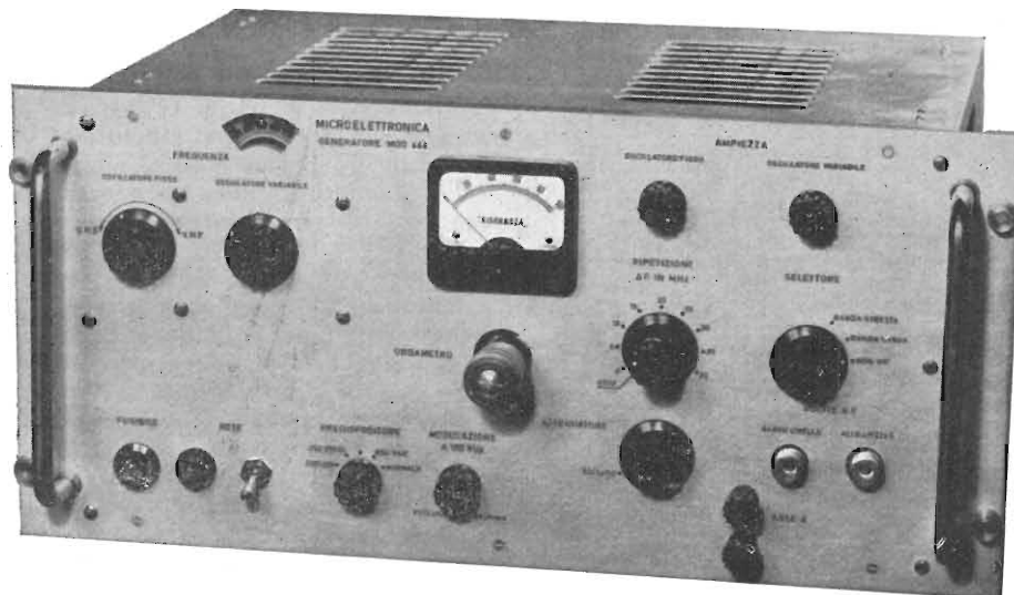
Fig. 3 - Un altro «sweep» e marker approntato per il mercato nazionale dalla SIAE.
