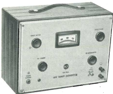
Fig. 2 - Lo « sweep » per UHF approntato dalla RCA per l'allineamento degli stadi alta frequenza dei convertitori e dei ricevitori TV.
